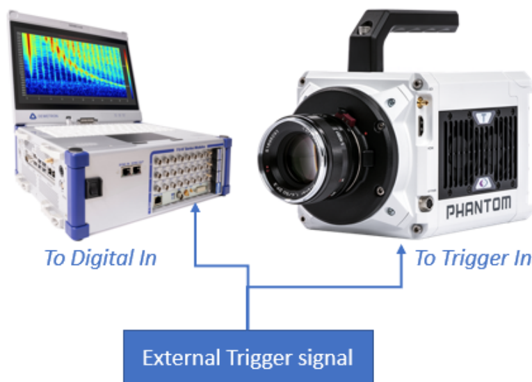
Fig. 7.163: 外部信号触发 DAQ 系统数据采集和相机录制启动
