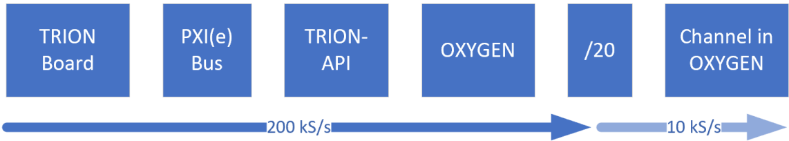
Fig. 7.39: 通道采样率选择器的工作原理
