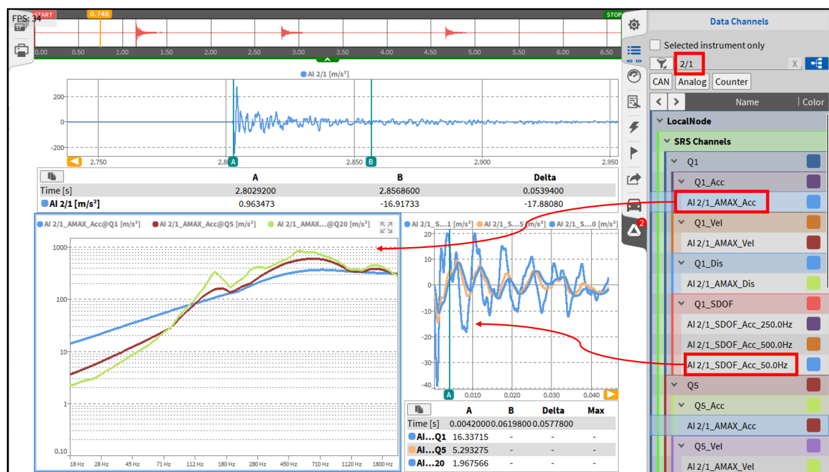
Fig. 7.154: 将 AB 光标链接为 SRS 计算的时间范围
