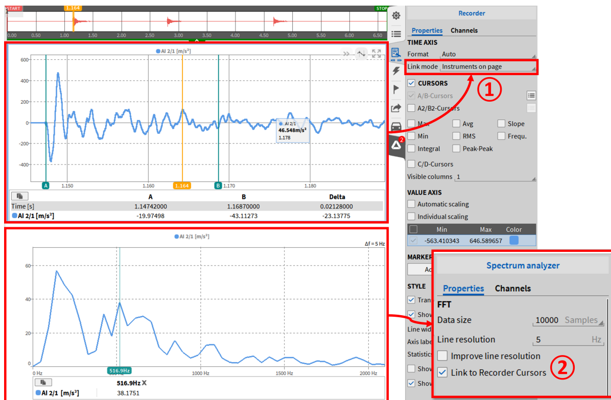
Fig. 8.79: 基于记录仪区域数据的频谱分析仪
