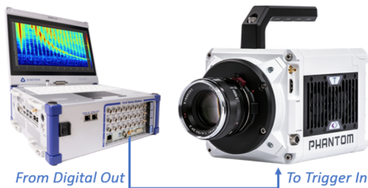
Abb. 7.165: Aufnahmestart der Kamera durch DaQ-System ausgelöst
